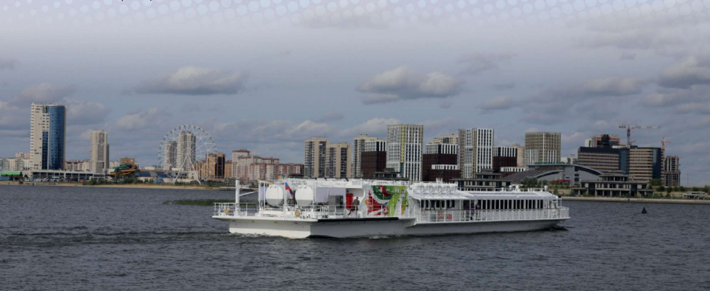
Рисунок 1. Прогулочно-экскурсионное судно-газоход "Чайка", вид с кормы. Видны емкости хранения СПГ на палубе
